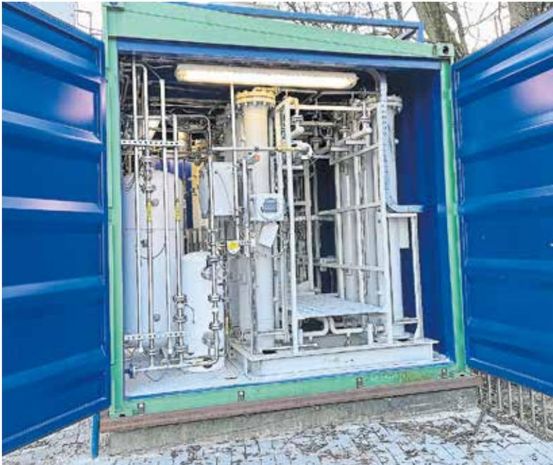
Ein Blick auf die Technik: Die senkrechten Röhren rechts gehören zur Druckwechselsorption. Das Ergebnis dieses Verfahrensschrittes ist reiner Wasserstoff.
